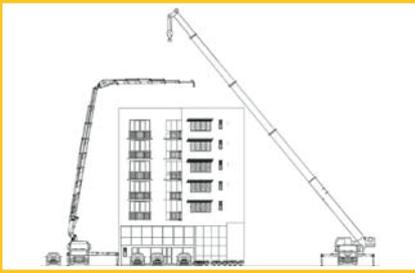
Das zusätzliche Knickgelenk ermöglicht eine bessere Platzierungsmöglichkeit des Kranes. Störkanten können umgangen werden. Der kleinere Kran braucht weniger Platz, ist wendiger und spart Kosten.
